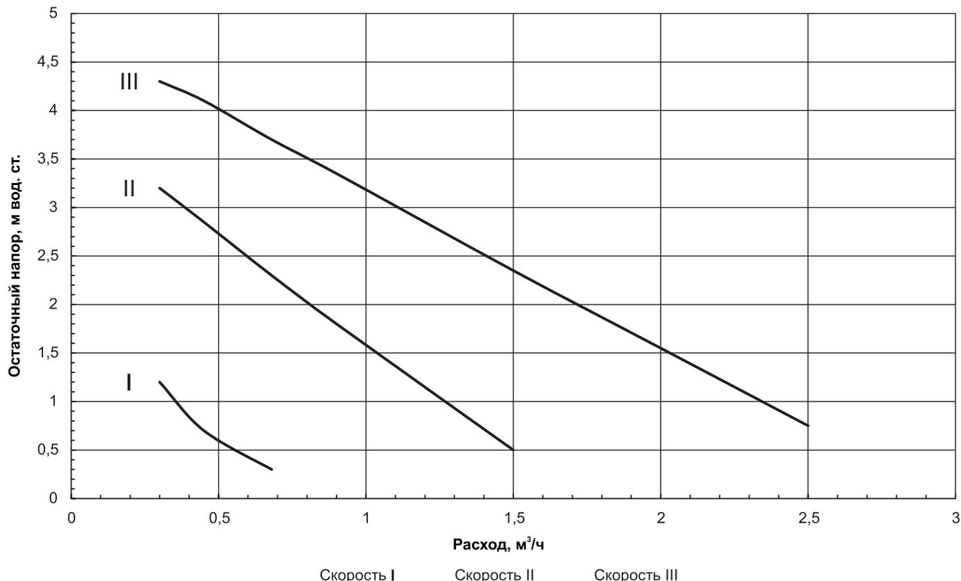
График 1 Остаточный напор для циркуляционного насоса
