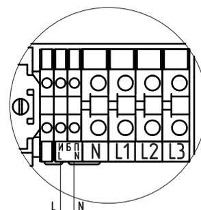
**Подключение ИБП или стабилизатора**
