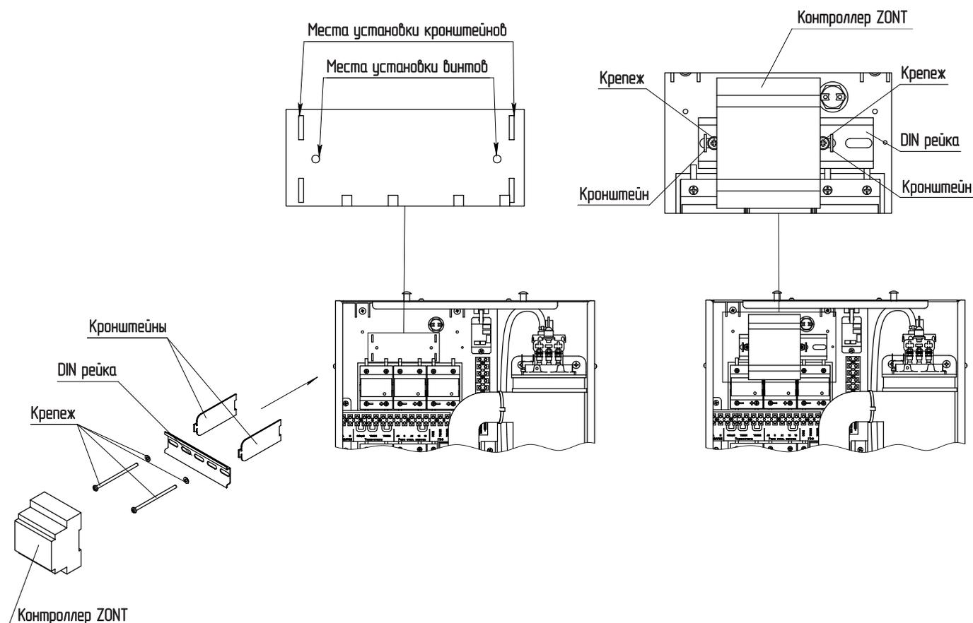
**Рис.6 Порядок установки контроллера ZONT для электрокотлов Uni-Termo ALTAY мощностью 6-9 кВт**
