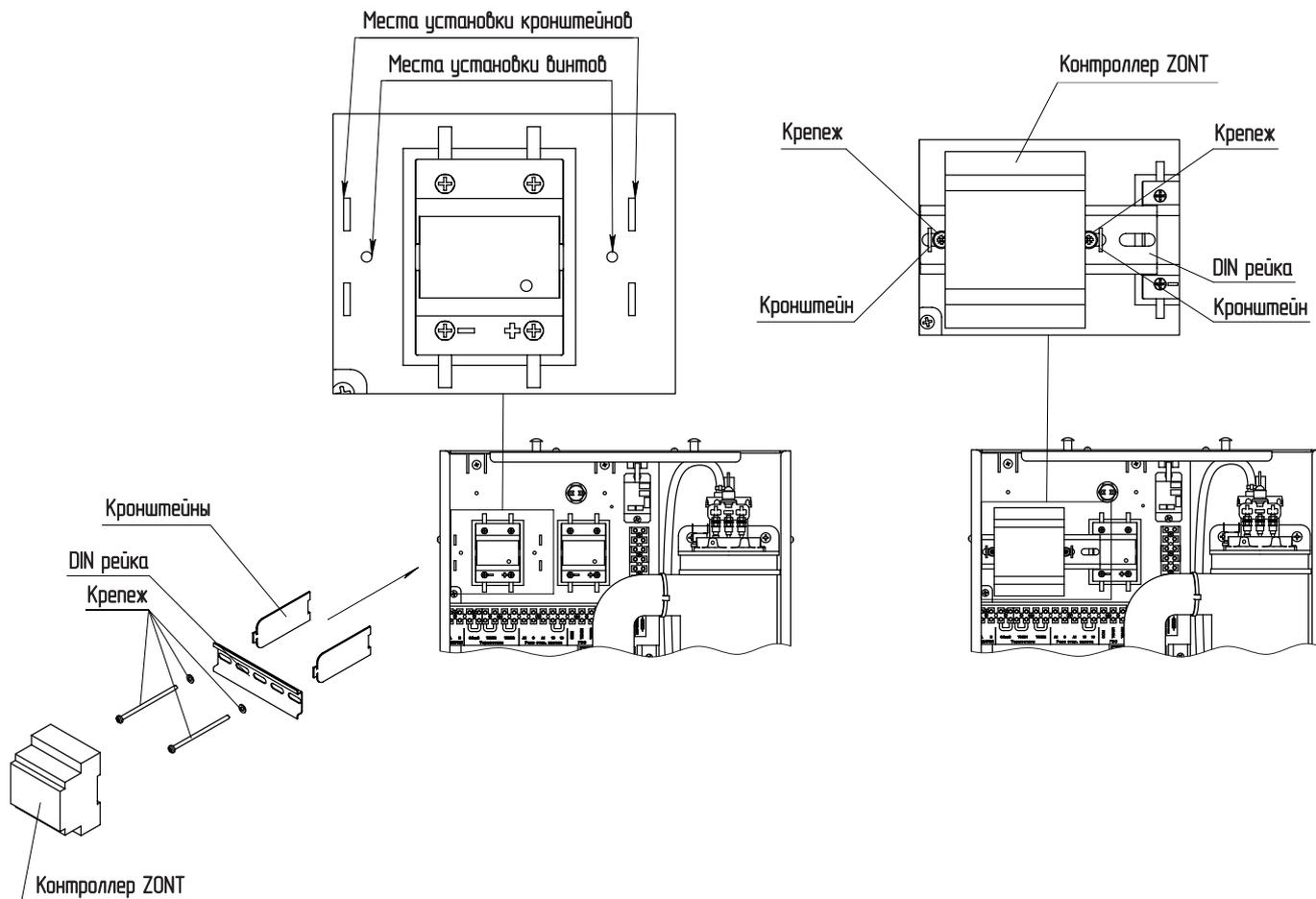
**Рис.6.1 Порядок установки контроллера ZONT для электрокотлов Uni-Termo ALTAY мощностью 12-15 кВт**
