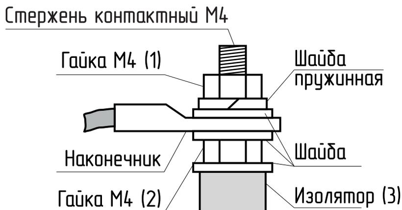
**Рис.8 Присоединение проводов к выводам блок ТЭН**
