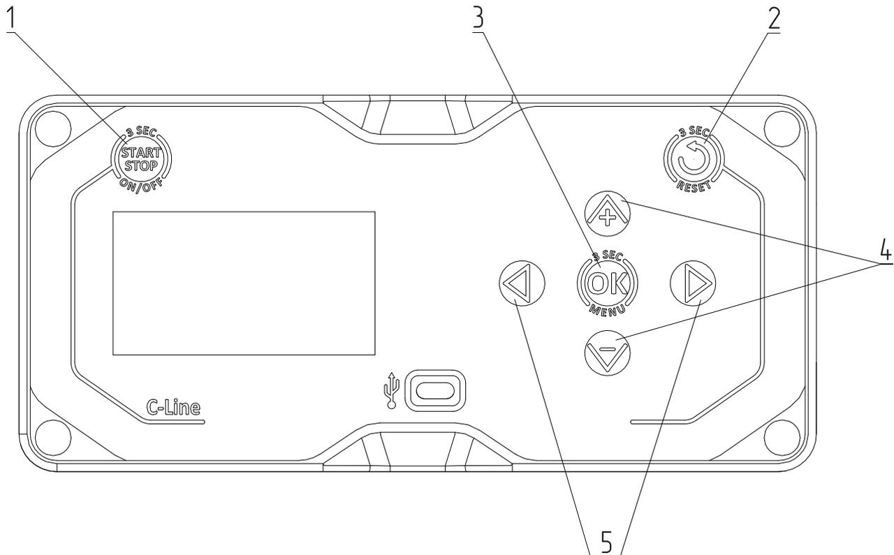
Рис. 10 Функциональные клавиши контроллеров ZOTA серии C-Line 200SFA
