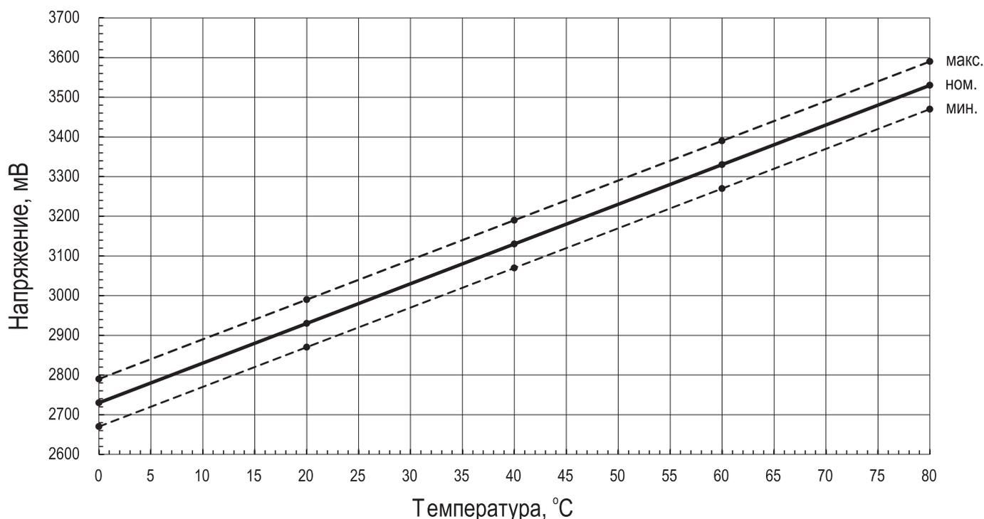
**Рис. 1** Напряжение на датчике в зависимости от температуры
