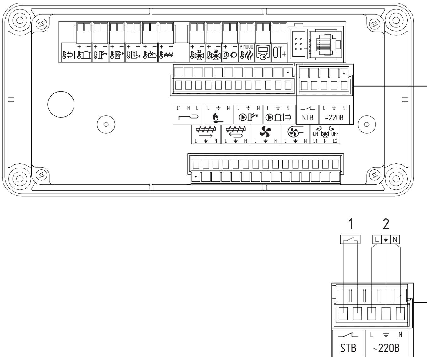
**Рис. 6** Схема подключения термоограничителя и шнура питания к контроллеру ZOTA серии C-Line 200SFA
