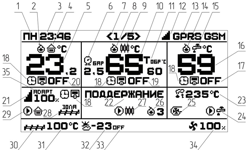
Рис. 11 Дисплей контроллера ZOTA серии C-Line 200SFA
