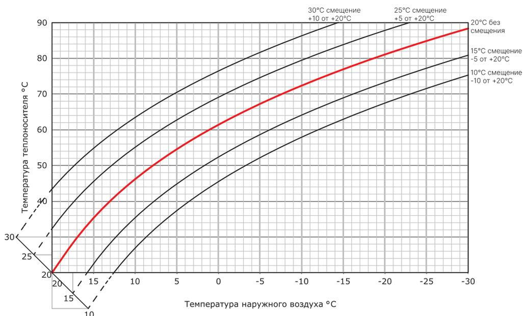
**Рис. 13** Смещение коэффициента кривой погодозависимого управления
