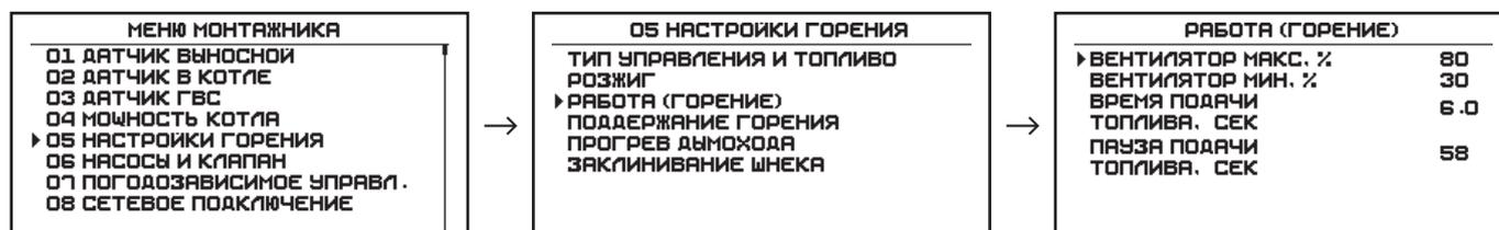
Далее запустите котел и настройте подачу воздуха в котел с помощью механической заслонки на вентиляторе наддува или пунктов меню «Вентилятор Макс.» и «Вентилятор Мин.» если механической регулировки на вентиляторе Вашего котла нет.
