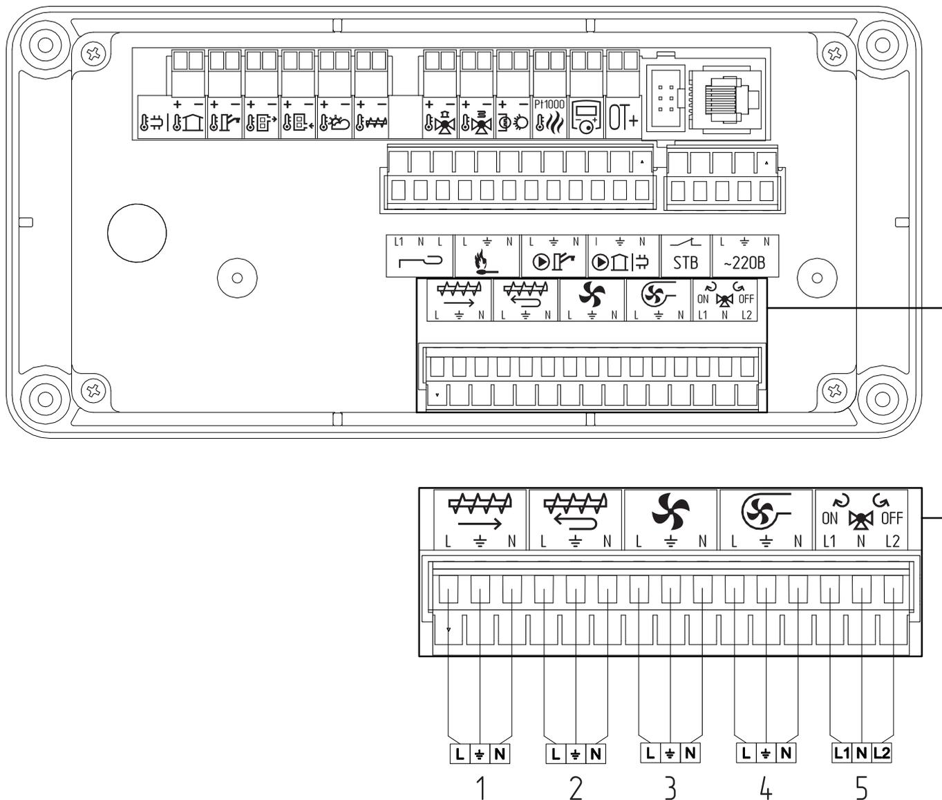
**Рис. 9** Схема подключения механизма подачи топлива, вентиляторов наддува, дымососа и смешительного клапана
