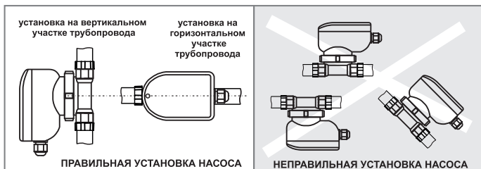
Рис.3 Установка циркуляционного насоса
