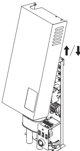
Рис.6 Демонтаж кожуха
