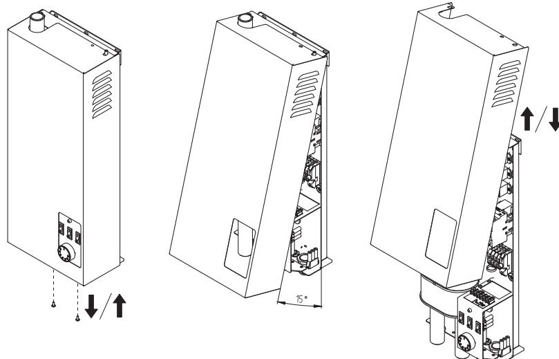
**Рис.6 Демонтаж кожуха**
