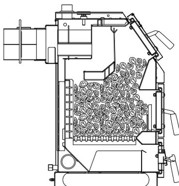
**Рис.11** Заполнение котла топливом для номинального режима
