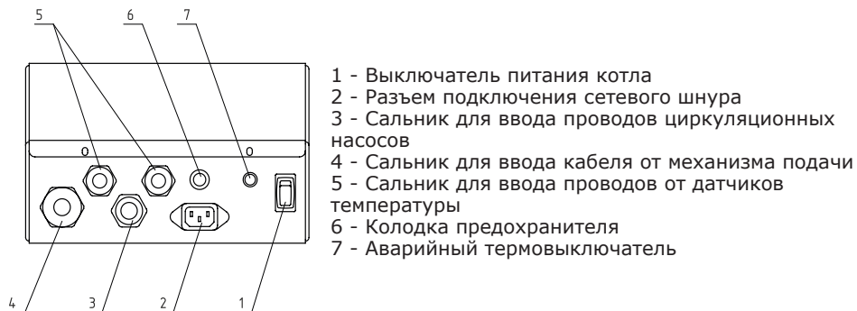
Рис.8 Расположение органов управления на задней панели пульта
