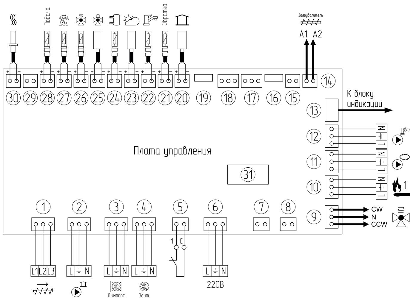
**Рис.5** Схема подключения контроллеров ZOTA серии I-Line 224SFA
