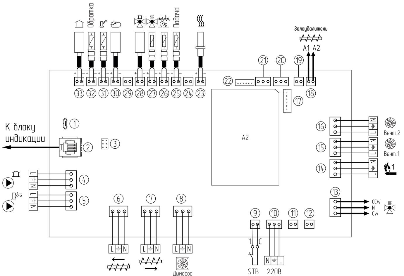
**Рис.4** Схема подключения контроллеров ZOTA серии R-Line 230SFA для котлов: Twist Plus, Cuba
