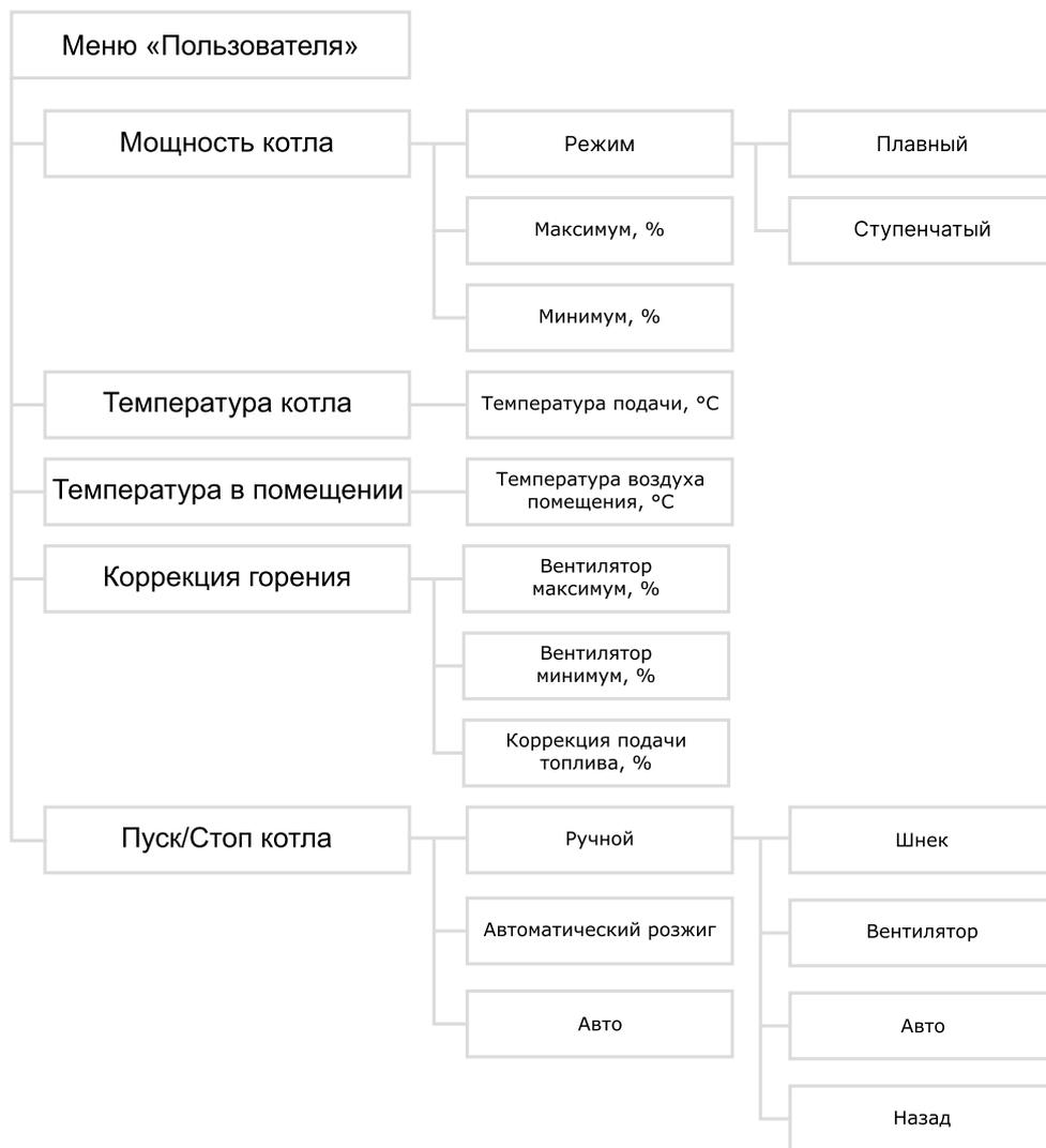
Рис.15 Блок-схема меню пользователя
