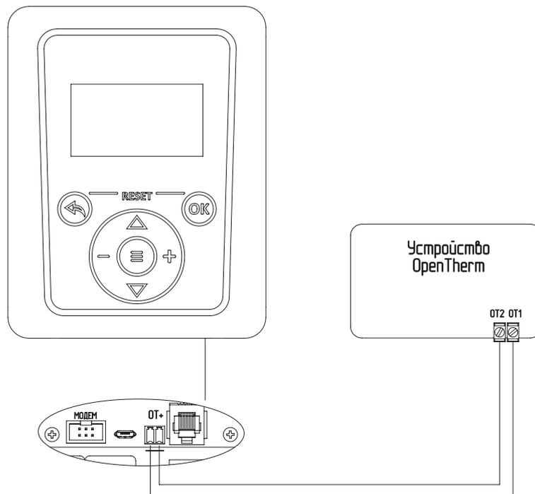
Рис.9 Схема подключения OpenTherm к плате блока индикации
